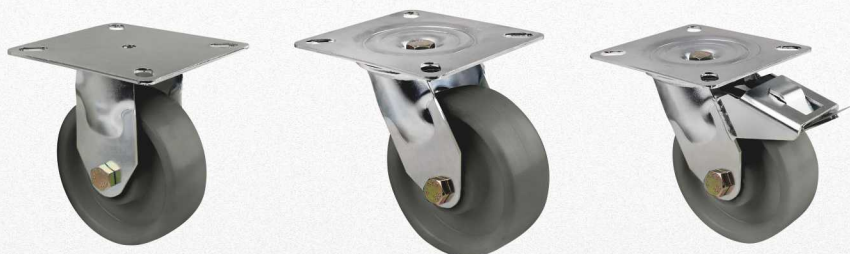
PL110X130 - Diâmetro da roda: 125 mm | Altura total do rodízio: 160 mm Eixo com ROLAMENTO | Capacidade de carga: 250 / 300 / 400 kg
